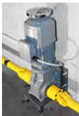
Motor mit Kardanwellen
