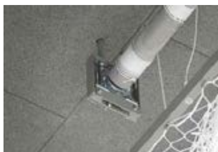
Antriebswelle lagerseitig (Abrollsicherung)
