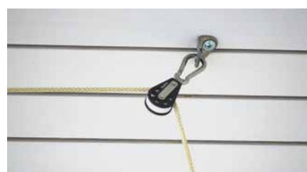
Umlenkung an Decke
